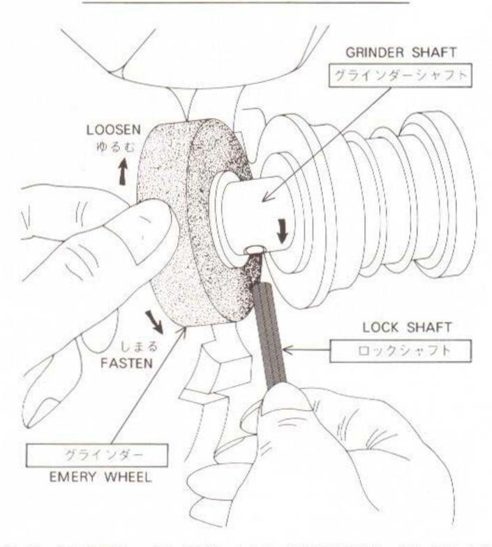
グラインダーを手で固定し、グラインダーシャフトの穴に付属のロックシャフトを差し込み、矢印の方向に回すとグラインダーがはずれます。古いグラインダーを取りはずし新しいグラインダーを取り付けます。
